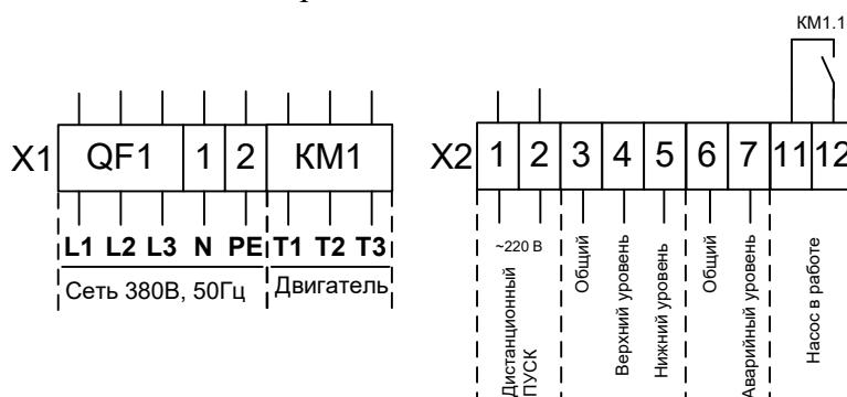
Рис.4 Схема подключения СУ-ЗН.
